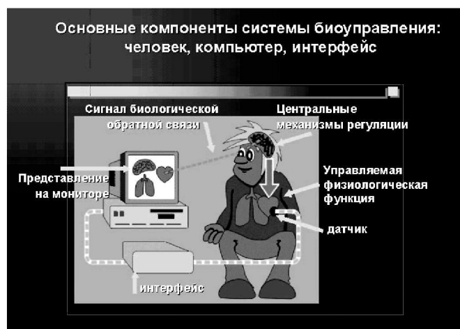
Рис. 1. Основные компоненты контура биоуправления: пациент, компьютер, датчики для регистрации информации, интерфейс, связывающий эти атрибуты технологии
